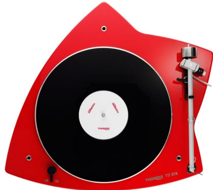
**Tonarm TP 90.** Der neu entwickelte Tonarm TP 90 basiert auf dem bewährten TP 92. Er verwendet wie dieser extrem reibungsarme Hochleistungslager sowie ein innovatives magnetisches Anti-Skating-System mit null Haftreibung. Das Tonarmrohr besteht aus gerolltem Aluminium, das mit Hilfe der RMR-Technologie bedämpft wird. An seinem Ende befindet sich ein doppelt entkoppeltes Gegen­gewicht aus Edelstahl. Tonarmhöhe, Azimuth und Überhang sind anpassbar.
